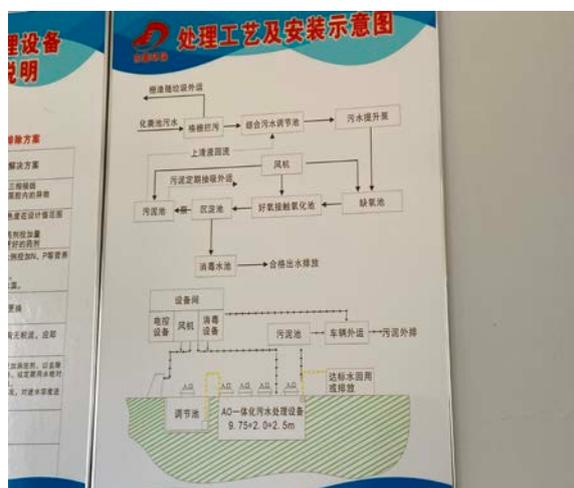
图 9 生活一体化污水处理工艺流程
